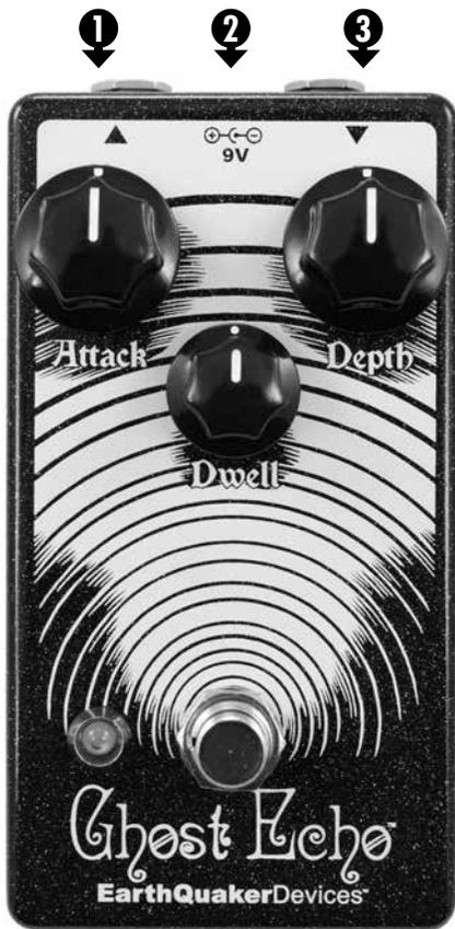
① **Attack:** プリディレイの設定。30msから150msまで調整できます。Dwellの設定を高くした際に起きるリバーブの発振の際にこのノブでエフェクト音のピッチを変える事ができます。
